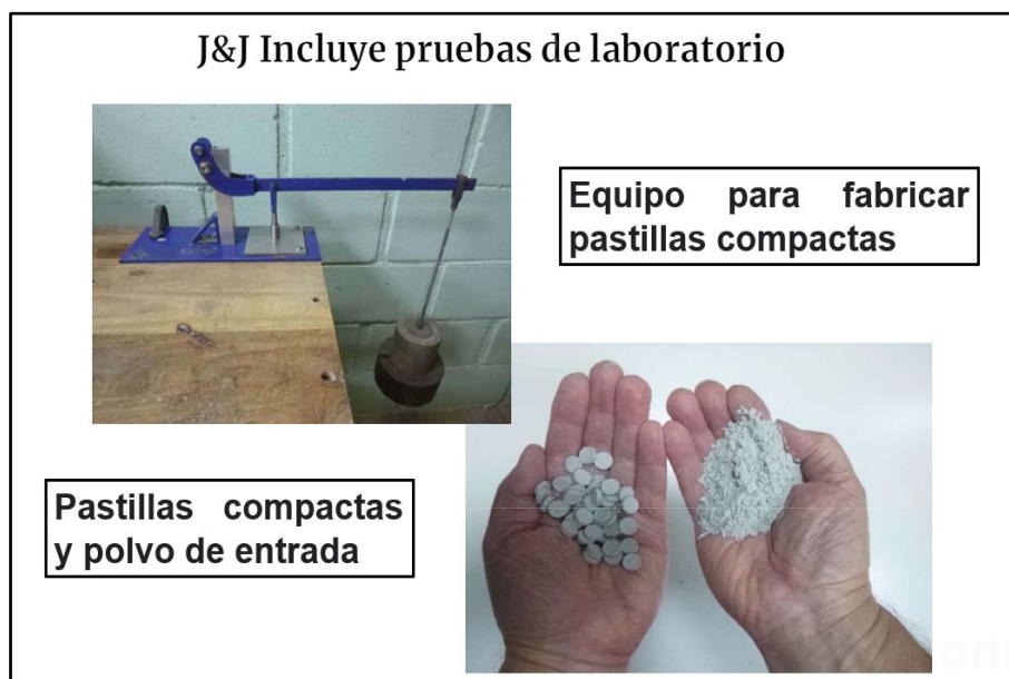
Figura 9: Granulación con polvo minero real por J&J [12]
